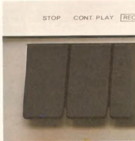
dienungs-Drucktasten zur Steuerung der verschiedenen Betriebsarten sind übersichtlich angeordnet; sie lösen mechanische und elektrische Steuerungsfunktionen wie Aufnahme, Wiedergabe, schnellen Vor- und Rücklauf, Stop, Pause, Continuous-Play aus und sind so gegeneinander verriegelt, daß eine Fehlbedienung des Gerätes ausgeschlossen ist.
