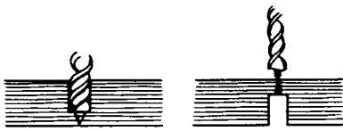
Рис. 188. Просверливание сквозных отверстий
