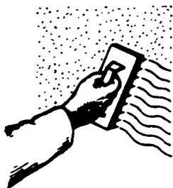
Рис. 156. Придание поверхности грунта шероховатости с помощью скребка
