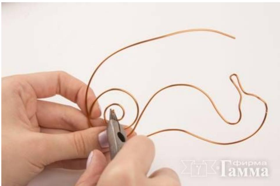
7. Чтобы соединить два отрезка в хвосте конька, обмотаем их тонкой проволокой диаметром 0.4 миллиметра в такой последовательности: дважды оба отрезка, дважды только один.
