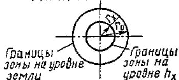
Рис. 37. Зона защиты одиночного стержневого молниеотвода:
