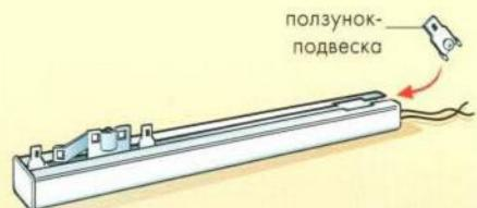
5. Закройте карниз двойным шкивом, вытягивая концы шнура через предусмотренное отверстие. Установите карниз и удостоверьтесь, что система работает.
