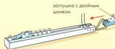
6. Для замены шнура в карнизе с раздвижными шторами, имеющим два ведущих ползунка (по одному на каждую штору), снимите карниз, разберите его, положите пазом вверх. Отрежьте шнур нужной длины и положите его в паз. У концов карниза завяжите на концах шнур петли и вставьте их в ведущие ползунки.
