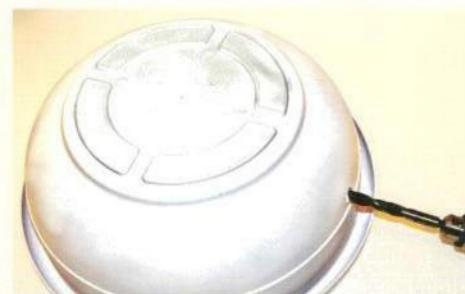
2. Установите распылитель на дне емкости и проведите шнур через боковое отверстие, для герметичности уплотните его резиновой пробкой.
