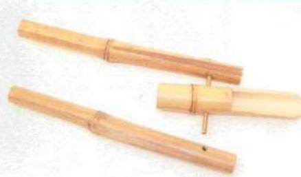
6. Вставьте телескопически соединенную трубку в нижнее отверстие длинной палочки и вытяните через кран. Отрежьте излишек трубы и соедините ее с насосом.
