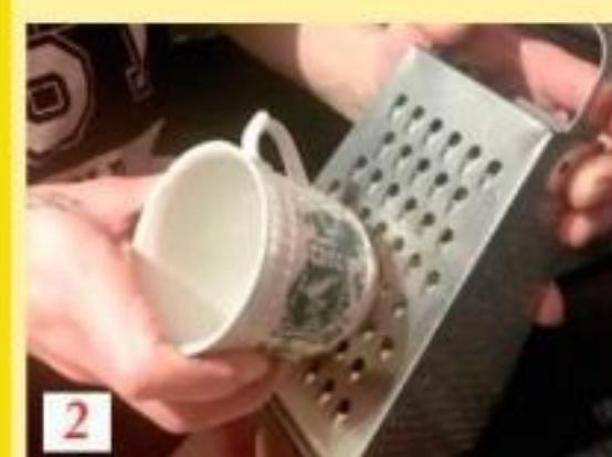
Перед заточкой терку вымыл и вытер ветошью. Подобрал чашку, на дне которой есть ободок (**фото 1**). Приложил «кружкоточило» к рабочей поверхности кухонного инструмента и, слегка прижав, прошелся кромкой по всем зубьям, как будто шинкуя овощ, примерно 30-40 раз (**фото 2**). Затем промыл терку теплой водой и проверил заточку — твердую морковь и вареную свеклу нашинковал вмиг. Процедуру заточки можно повторить при необходимости.
