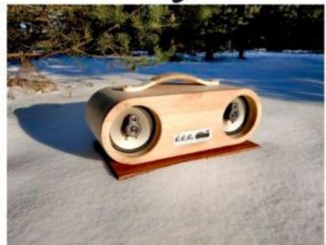
наждачной бумагой. Изнутри проклеил слой ткани для шумоизоляции. В разъемах закрепил колонки и блок управления, спаял их проводами. После к блоку дополнительно припаял усилитель, аккумулятор на 12 В и разъем AUX (**фото 4**).
