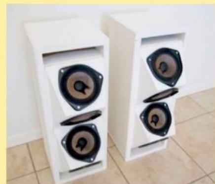
■ Учитывая размеры динамиков, определился с высотой и шириной корпуса. Из обрезков выпилил детали необходимого размера и на клей ПВА Столярный и саморезы собрал короба, сначала сделал один (**фото 1**), затем такой же второй.
