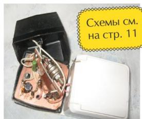
по схеме (**см. рис на стр. 11**) устройство регулятора, вывел провода и подсоединил их к контактам розетки (**см. фото внизу**). Собрал
