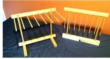
20 см, прикрепил саморезами короткие бруски — это ножки. В верхнем бруске на боковой грани насверлил несколько глухих отверстий d 2 см и глубиной 3 см и вставил в них деревянные штыри длиной 40 см. Для надежности место соединения можно промазать kleem по дереву. На грани со штырями дополнительно просверлил два отверстия на уровне соединительных черенков, чтобы конструкцию можно было складывать для хранения. На такой подставке помимо полотенец удобно сушить обувь.
