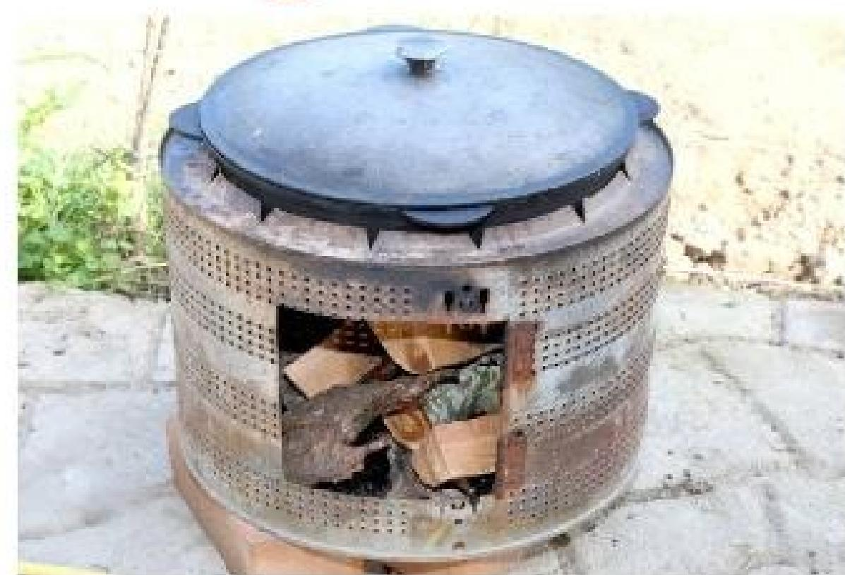
■ На кромке открытой части барабана стиральной машины выполнил ножницами по металлу надсечки примерно на равном расстоянии друг от друга. Затем плоскогубцами отогнул металл вверх. В итоге у меня получился отверстие нужного диаметра, как раз под мой казан.
