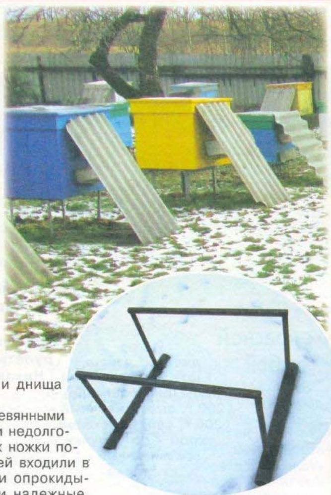
положить на землю два отрезка трубы диаметром 50-60 мм длиной 60 см и далее две детали буквой П. Материал любой - арматура, трубы, уголки, нужные вам по высоте и ширине. Все это сваривается сваркой. Все - подставка готова!
