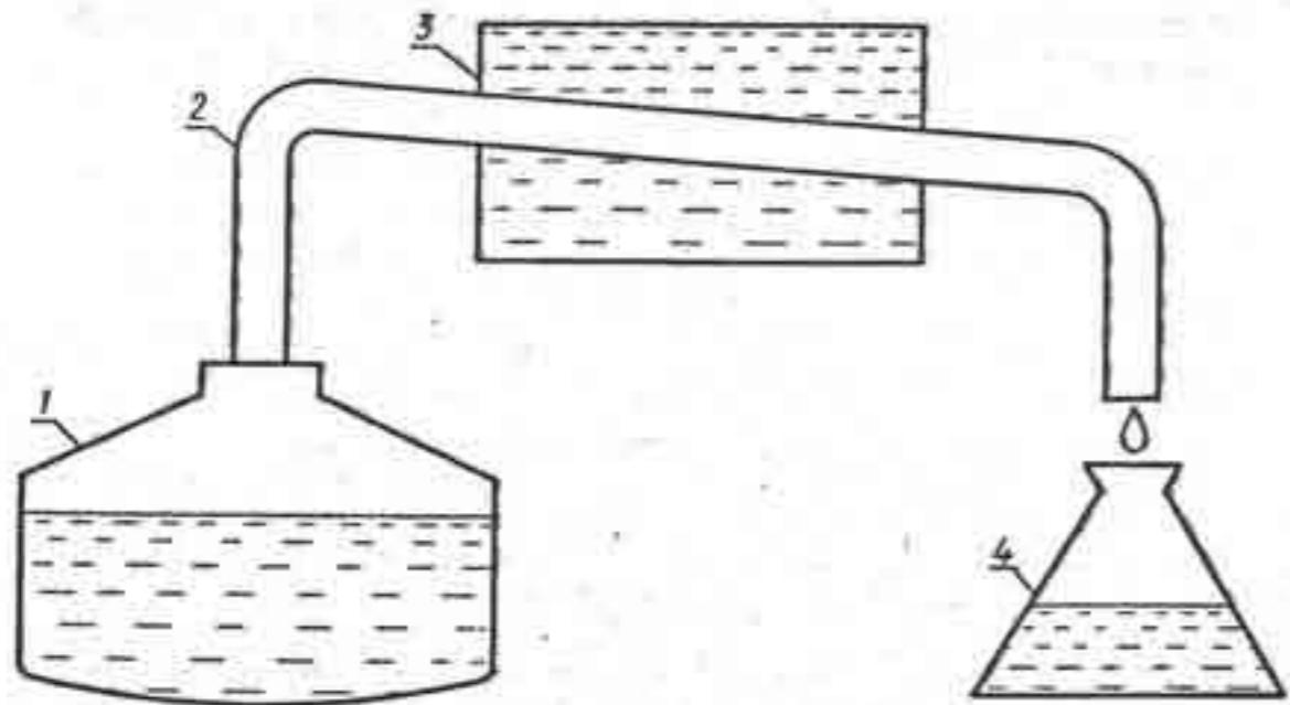
Рис. 1. Принципиальная схема самогонного аппарата:
