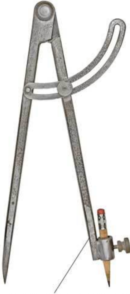
разметочный кронциркуль с держателем для карандаша
