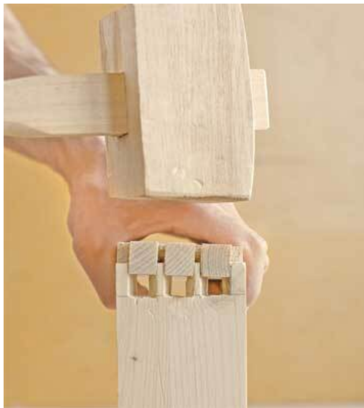
24. Готовое соединение ласточкин хвост (фото 24.1, 24.2).
