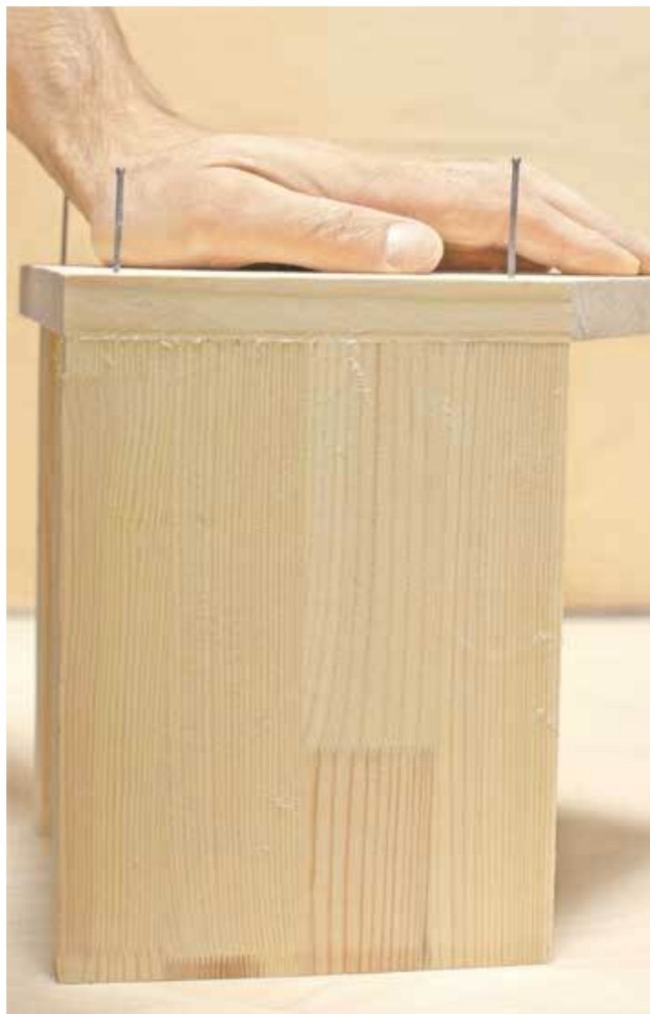
16. Придерживая детали рукой, аккуратно забиваем гвозди (фото 16).
