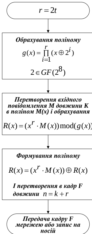
Рис.1. Схема алгоритму кодування інформаційного повідомлення із застосуванням коду Ріда-Соломона
