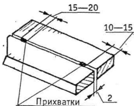
4. Затем места прихваток зачищаем проволочной щеткой. Сметаем мусор волосяной щеткой.
